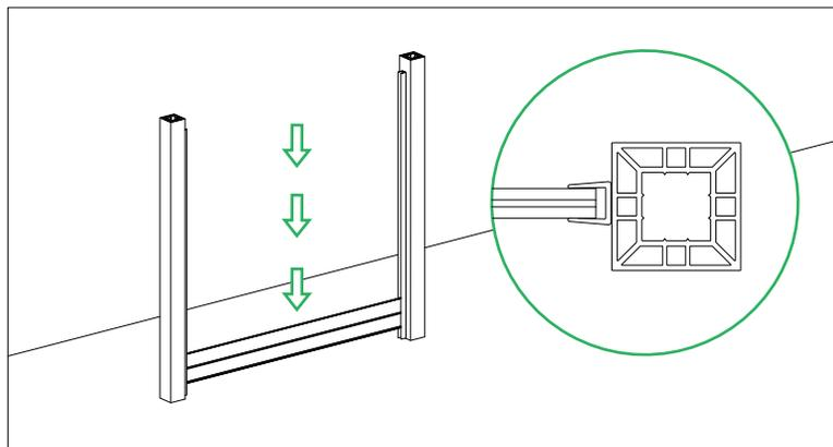
Таким же образом вставляется следующий профиль, задвигается до конца в паз нижнего профиля. Операции повторяются до достижения желаемой высоты забора.
