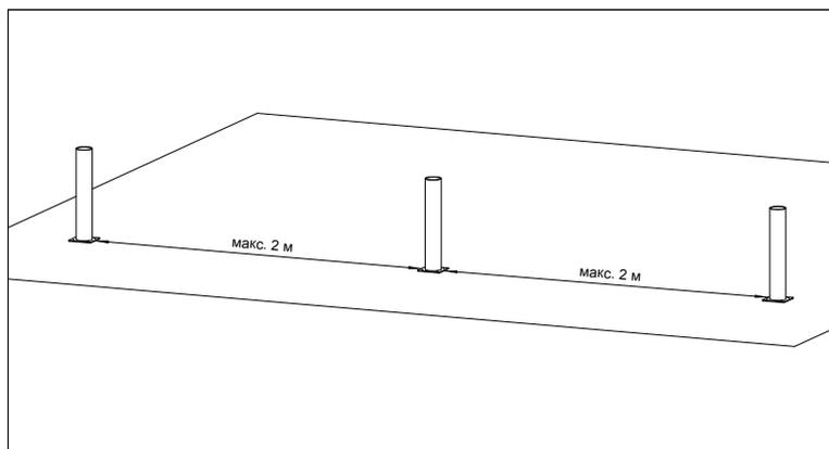
Монтаж армирующих профилей к основанию производится при помощи анкерных болтов. Для наибольшей прочности конструкции основание армирующего профиля заливается в бетон.
